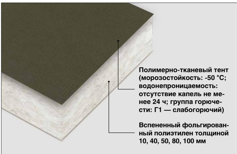
Покрытие ТМК обеспечивает во внутреннем пространстве широкий спектр температурных режимов, а также его влаго- и пожарозащищенность. Варианты покрытия: однослойное — водонепроницаемый, огнестойкий полимерно-тканевый тент; комбинированное — полотно типа «сэндвич» из двух слоев тента и морозостойкого утеплителя.
