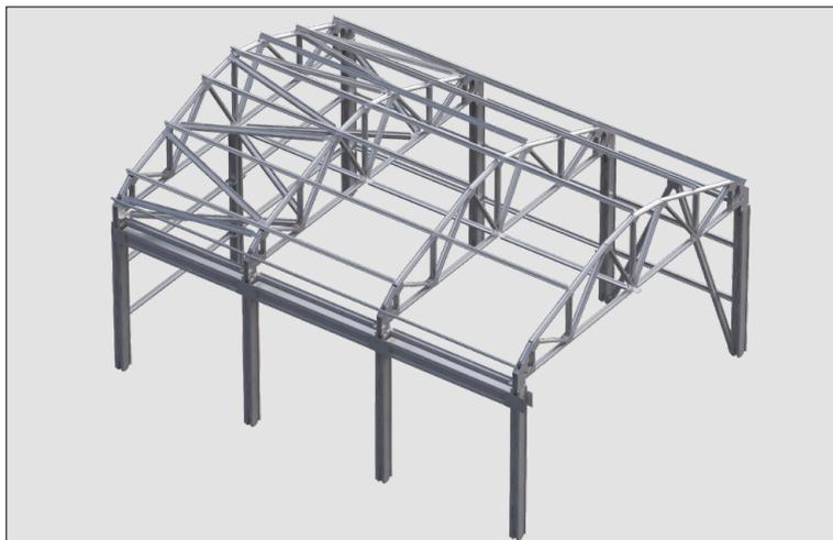
Каркас из тонкостенных (2,5 мм) холоднокатаных оцинкованных сигма-профилей из стали S350GD и оцинкованных соединительных элементов из стали S345 не подвержен коррозии и долго сохраняет свои эксплуатационные характеристики в любых климатических условиях.
